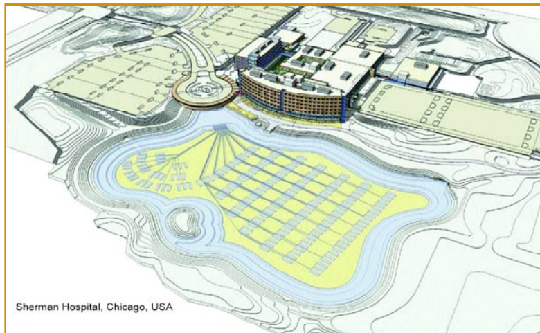
Ejemplo de uso de la energía geotérmica contenida en una masa de agua para la climatización de un hospital en Chicago
